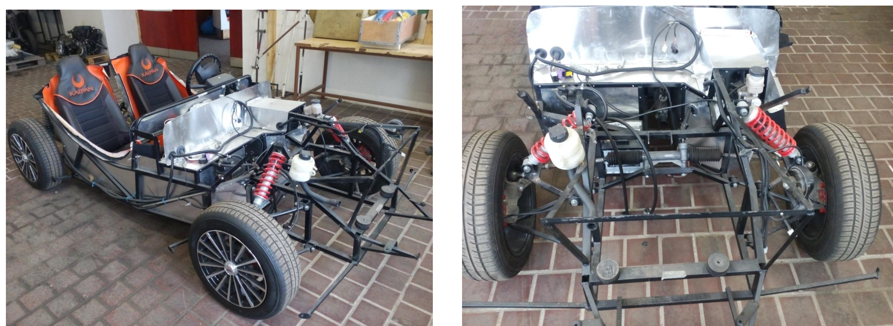
Obr.1. Trubková příhradová konstrukce chassis KAIPAN 415
