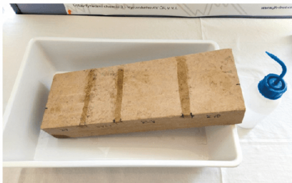
Pískovcový kvádr ošetřený hydrofobizací, tmavší pruhy prozrazují, kam vědci aplikovali novou emulzi.
